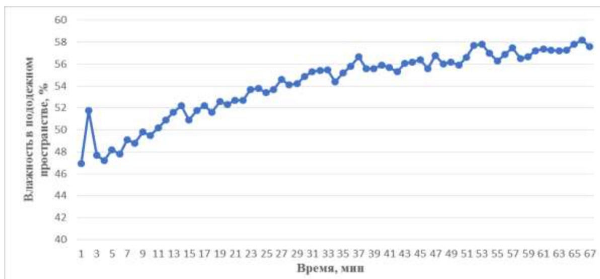
Рисунок 2. Изменение влажности в пододежном слое пакета 2, при параметрах окружающего воздуха: T= 27 °С; W =16 %
